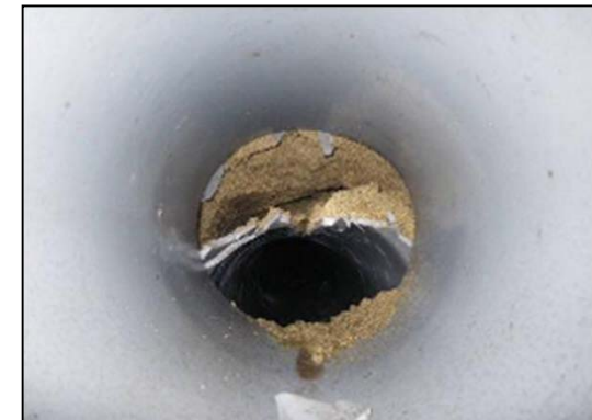
Daño a la tubería de PVC causado por el terremoto
