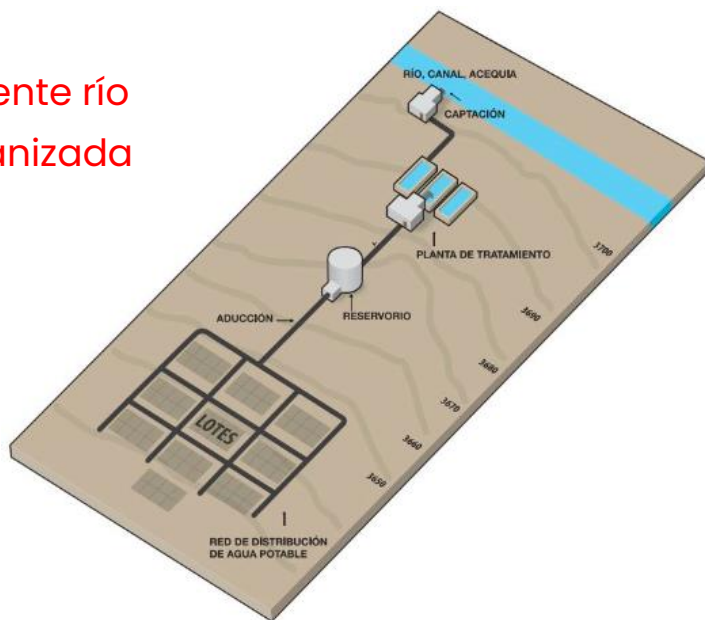
Sistema por gravedad con tratamiento
