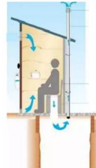
UBS Hoyo Seco Ventilado
