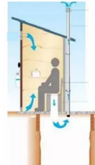
UBS Hoyo Seco Ventilado
