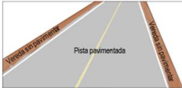
Vía con vereda en terreno natural
