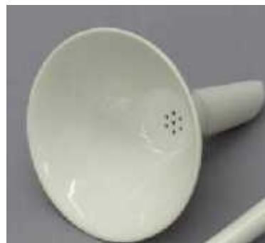
La diferencia entre los embudos Buchner y Hirsch es la capacidad volumétrica que poseen:
