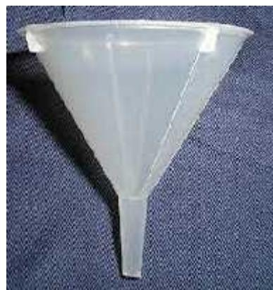
2. **Embudo de filtración.**- En forma de cono con vástago largo; se utiliza principalmente para la filtración de líquidos o en la transferencia de líquidos de un recipiente a otro.
