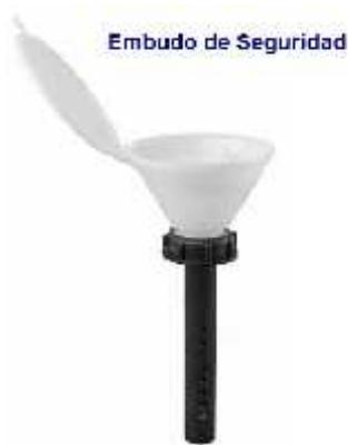
10. **Embudo de filtración magnético:** De material Polifenilsulfona, esterilizable en autoclave. Se usa para técnicas de filtrado por membrana en análisis de agua. El cierre magnético anti fugas permite la manipulación con una sola mano, compatible con agentes antiespumantes y otros disolventes.
