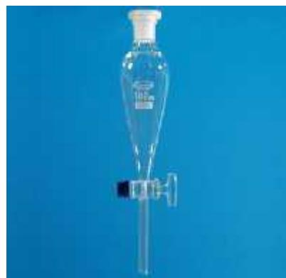
6. **Embudo de adición o de goteo:** Es graduado ascendente y descendente, tiene una llave que permite que el líquido sea añadido a un frasco lentamente.
