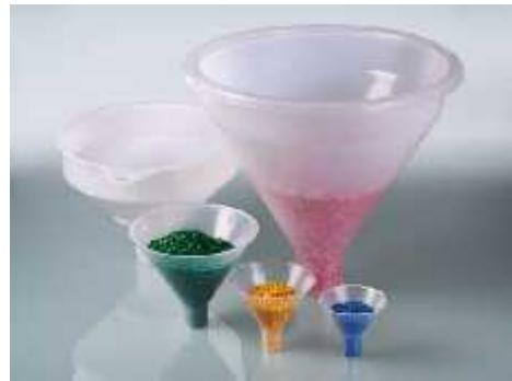
9. **Embudo de seguridad:** Los embudos de seguridad permiten un vertido de líquidos peligrosos sin ningún peligro. Sin derrames. Están fabricados en teflón de alta calidad, resistente a ácidos y disolventes.
