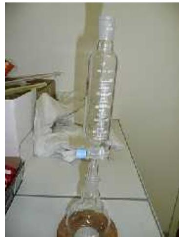
7. **Embudo cilíndrico, con tubo compensador y/o embudo de decantación, cilíndrico con compensación de presión.-** Con graduación ascendente y descendente en mililitros con tubo lateral. Para mantener su presión compensada (la presión que se encuentra dentro del reactor será la misma dentro de la ampolla, por lo que se podrá dosificar el contenido de ésta sin problema) macho esmerilado inferior 24/40, llave de descarga de Teflón. Tapón superior plástico, pico gotero para su descarga.
