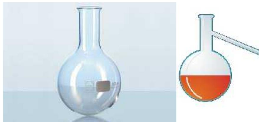
**5) Matraz Recolector o Receptor:** Es un frasco de vidrio, de cuello muy corto, cuerpo esférico y boca esmerilada. Está diseñado como pieza de vidrio en los evaporadores rotativos, para recolectar las destilaciones de reacciones con reflujo. Está hecho generalmente de vidrio borosilicato.
